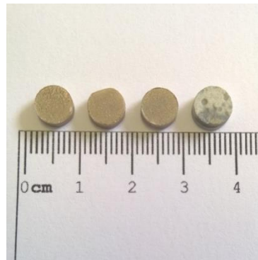
Figura 24: Fotografia das amostras contendo, da esquerda para a direita: SrTiO 3 + 0,025% mol Pr, SrTiO 3 + 0,050% mol Pr, SrTiO 3 + 0,075% mol Pr, e SrTiO 3 + 1% mol Pr.
