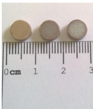
Figura 26: Fotografia das amostras contendo: (a) \text{SrTiO}_3 + 1% mol Ca, (b) \text{SrTiO}_3 + 2,5% mol Ca e (c) \text{SrTiO}_3 + 5% mol Ca.
